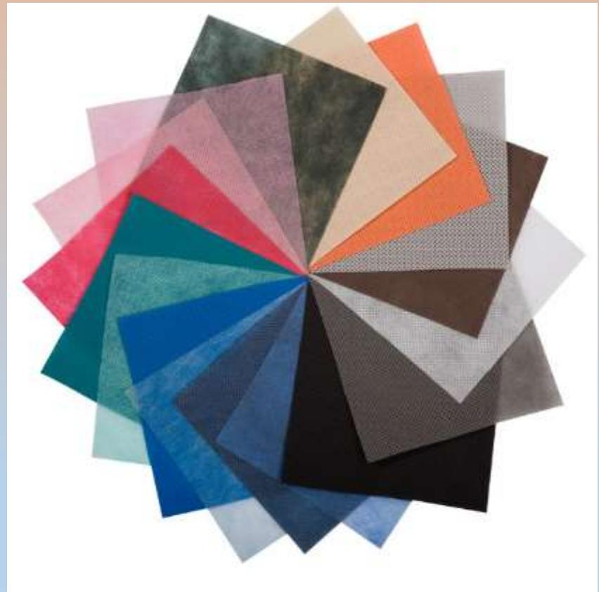
Нетканые материалы, выработанные непосредственно из текстильных волокон или систем нитей, связываемых непосредственно механическим или физико-химическим способами.
